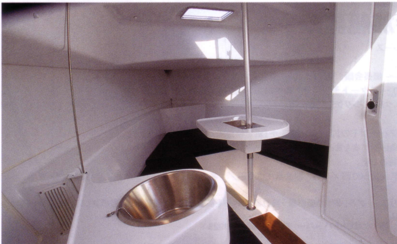
シンプルな構造のキャビンは、175cmのヘッドクリアランスを確保。24フィート艇としては広いといえる
