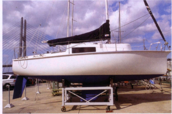
さまざまなシーンでのクルージングを考慮し、吃水は1.2mと浅い。ラダーの強度を確保するために、フルスケグ&アウトラダーの組み合わせが採用されている
