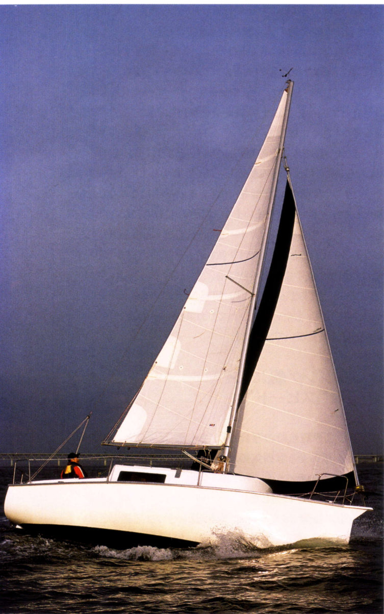
信天翁24。ボリューム感あるミジップ部分と比較して細身のバウエントリーと、船内にバルクヘッドがなくバウが軽いため、波がバウをたたく感触が軽い。大きな波の中での試乗はできなかったが、不快なピッチングが少ないことが推測できる
