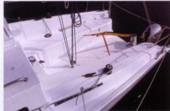
左：高いコーミングで囲まれたコクピット。トラベラーシステムがないなどシンプルな構造で、広く使える
