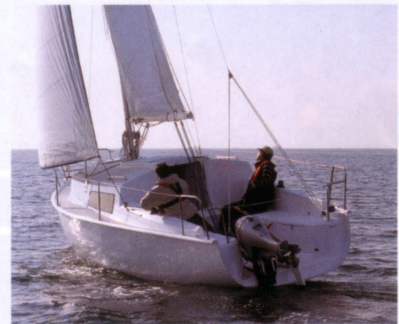
海面と引き波の状態から、比較的弱い風の中でも、スピードが出ていることが分かる。この程度の風ならほぼニュートラルヘルム。クルージング艇としては少数派のオープントランサムが採用されている
