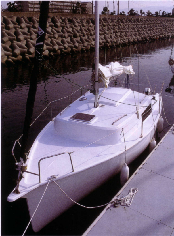
大きく盛り上がった箱型のドッグハウスがクラシカルな雰囲気漂わせる。作業時の安全のため、デッキのほぼ全面にノンスリップパターンが配されている
